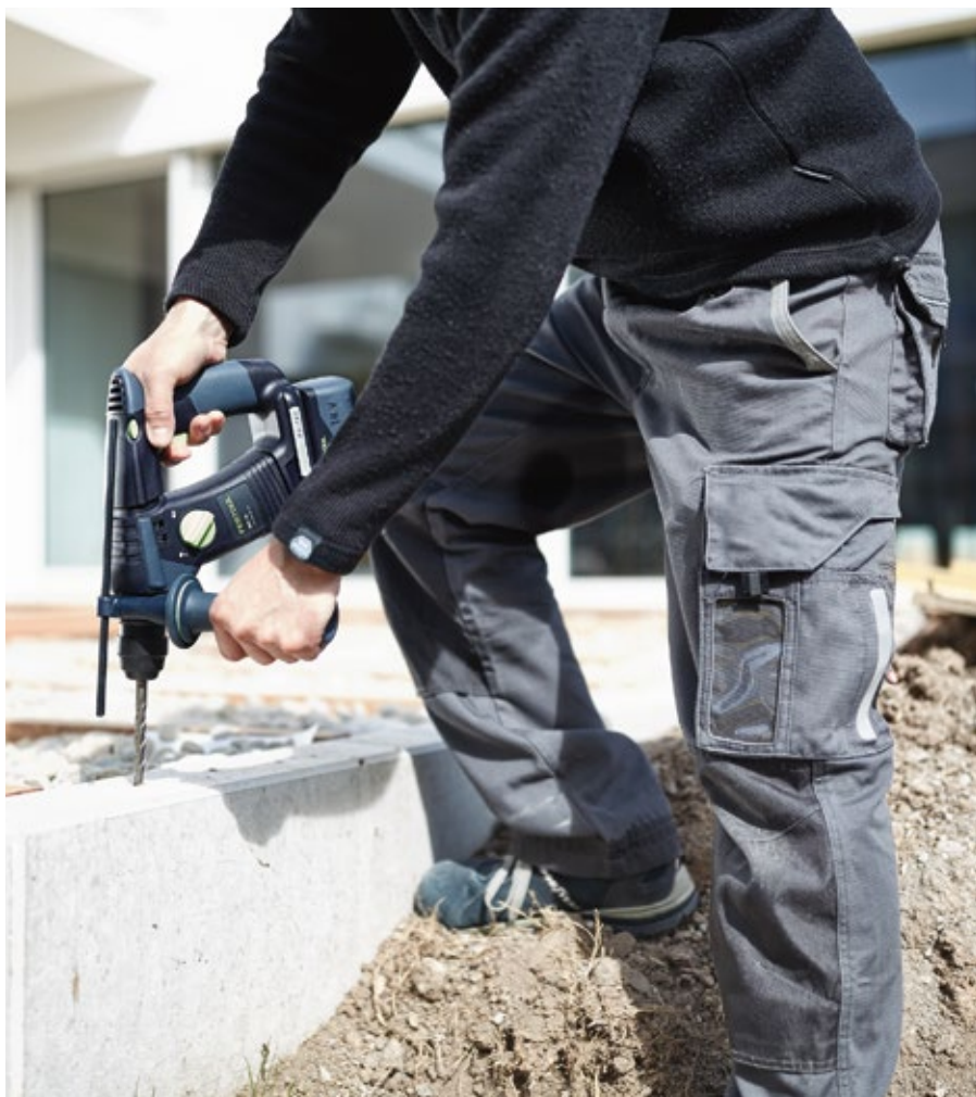
Robustný silák na betón: Špecialitou vŕtačky BHC 18 sú otvory s pneumatickým príklepom až do 18 mm v betóne, kameni a v murive.
